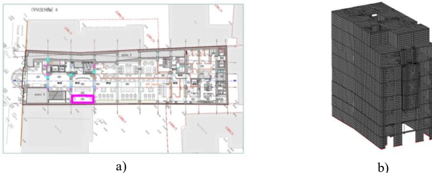
Slika 3: (a) Osnova prizemlja: novoprojektovano stanje sa novim nosećim elementima; (b) trodimenzionalni model konstrukcije Hotela Union
