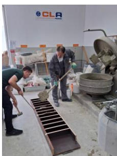
Slika 3: Pripremanje betonskih uzoraka za ispitivanje (levo i u sredini) i Aplikacija zaštitnih premaza (desno)
