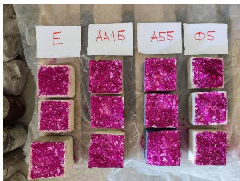
Slika 4: Step en karbonatizacije betona nakon 28 i 56 dana izloženosti “E” – Etalon; “AA1B” – Adingpoks Akva 1B; “ABB” – Antikorozin BB; “FB” – Fasil V
