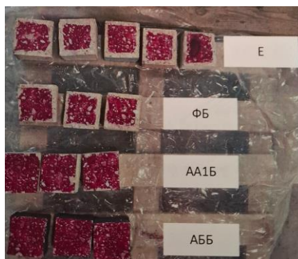
Slika 4: Step en karbonatizacije betona nakon 28 i 56 dana izloženosti “E” – Etalon; “AA1B” – Adingpoks Akva 1B; “ABB” – Antikorozin BB; “FB” – Fasil V
