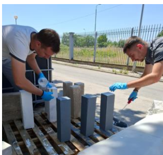
Slika 3: Pripremanje betonskih uzoraka za ispitivanje (levo i u sredini) i Aplikacija zaštitnih premaza (desno)
