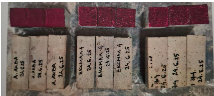
Slika 5: Ispitivanje reparaturnih maltera nakon 56 dana izloženosti ubrzanoj karbonatizaciji
