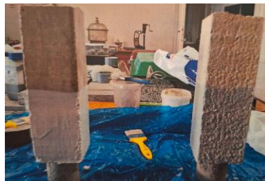
Slika 3: Pripremanje betonskih uzoraka za ispitivanje (levo i u sredini) i Aplikacija zaštitnih premaza (desno)
