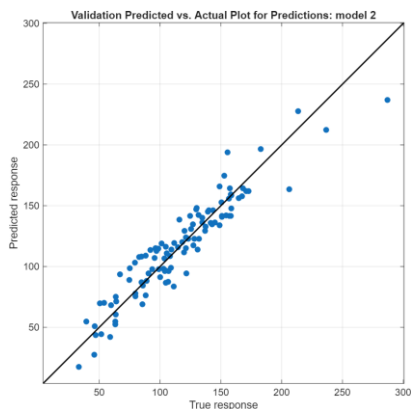
Slika 6: Poređenje numerički dobijenih i predviđenih vrednosti smičuće sile u AB serklažima (SF) primenom modela linearne regresije.
